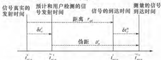
图 7.6 发射机和接收机时钟不同步对距离测量的影响
