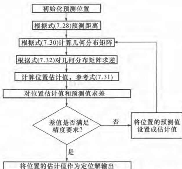
图 7.17 迭代的单历元定位计算的过程(不考虑超定的情况)
