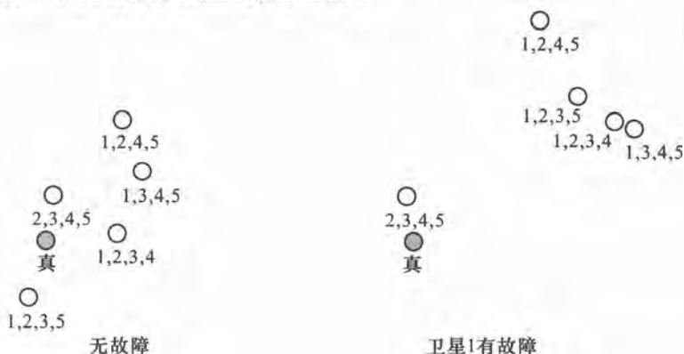
图 17.5 区分根据不同 GNSS 信号组合计算的位置参数
